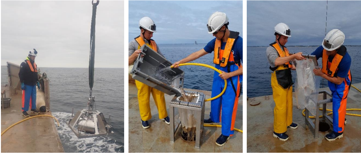
Figure 3 : Etapes de prélèvement et de conditionnement des échantillons, de gauche à droite : remontée de la benne Day, tamisage d'un réplikat (contenu du bac de criée), mise en sac plastique étanche (source : TBM environnement).
